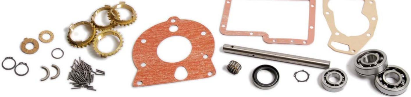
**IF YOU'VE HAD TO STRIP YOUR GEARBOX, USE OUR GEARBOX OVERHAUL KIT WHEN RE-BUILDING. PHOTO SHOWS OVERHAUL KIT FOR SINGLE-RAIL TYPE GEARBOX.**
