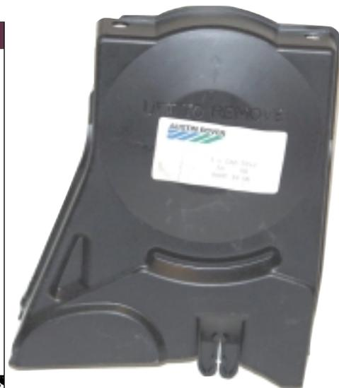
TIMING BELT COVER 4 CYLINDER CAM5941
